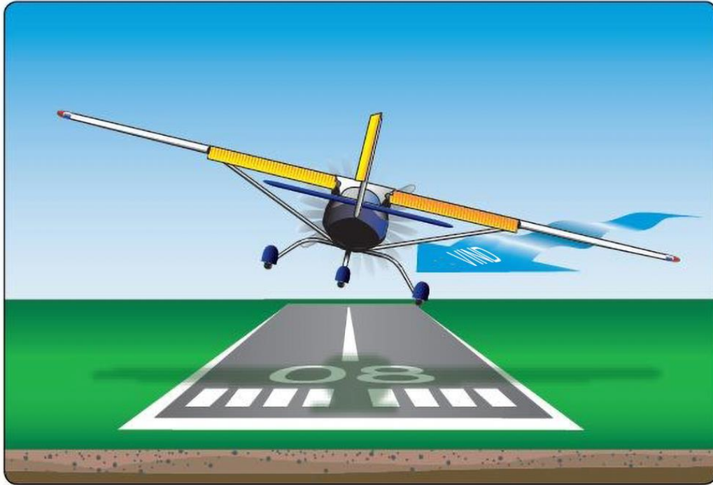
Figur 2 Slip metoden. Hold lav vinge mot vinden med balanseror, og styr retningen med siderorspedalene
